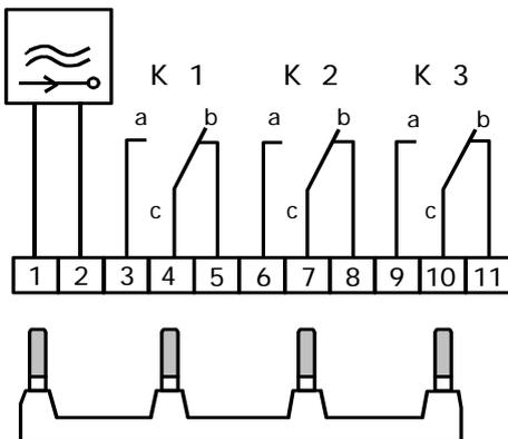
Phasenbrücke zum Verbinden von L mit den Relaiswurzeln von K1-K3 (Bestellnummer 4 422 1625 0).
